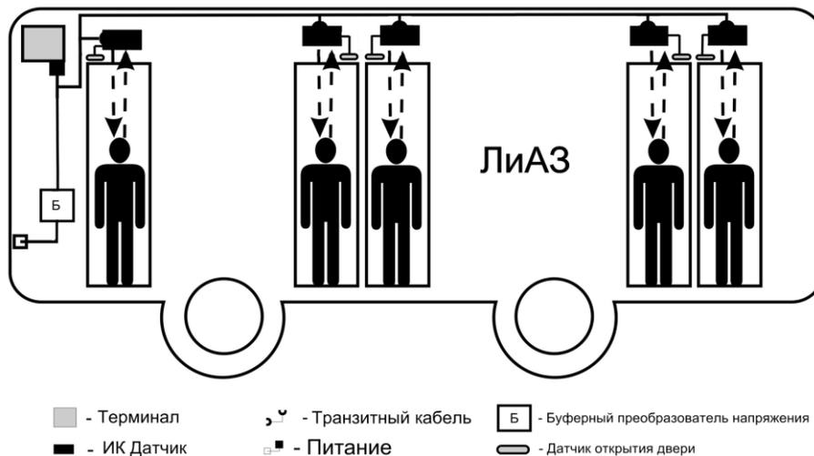
Рисунок 7 – Пример установки системы на 3-дверный (5 створок) автобус.
