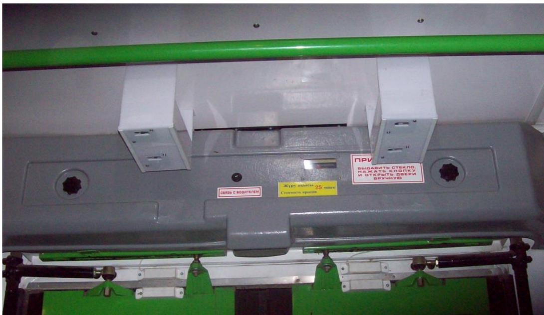
Рисунок 3.2 – Установка на двухстворчатую дверь автобуса ЛиАЗ ИК-датчиков «Луч-МС».
