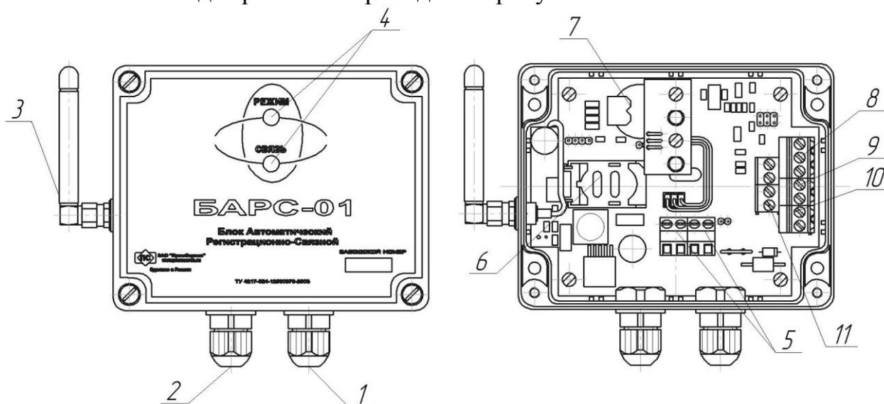
Рисунок 2 – Внешний вид терминала «БАРС-01-Т».
