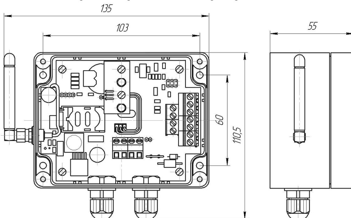
Рисунок А.1 – Габаритные и присоединительные размеры терминала «БАРС-01-Т».
