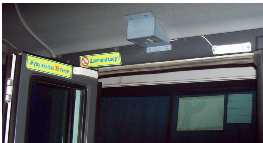
Рисунок 3.2 – Установка на одностворчатую дверь ИК-датчика «Луч-М».
