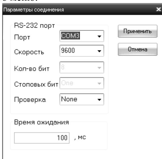
Рисунок Е.1 – Настройка параметров соединения.
