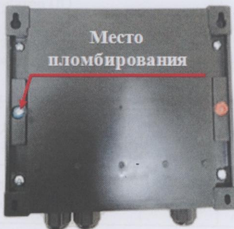
Рисунок 10 – Пломбирование тепловычислителя СПТ941
