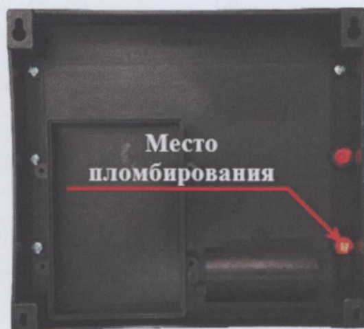
Рисунок 9 – Пломбирование тепловычислителя СПТ944
