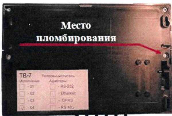
Рисунок 5 – Пломбирование тепловычислителя ТВ7
