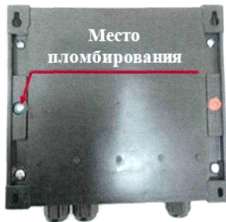
Рисунок 6 – Пломбирование тепловычислителя СПТ941
