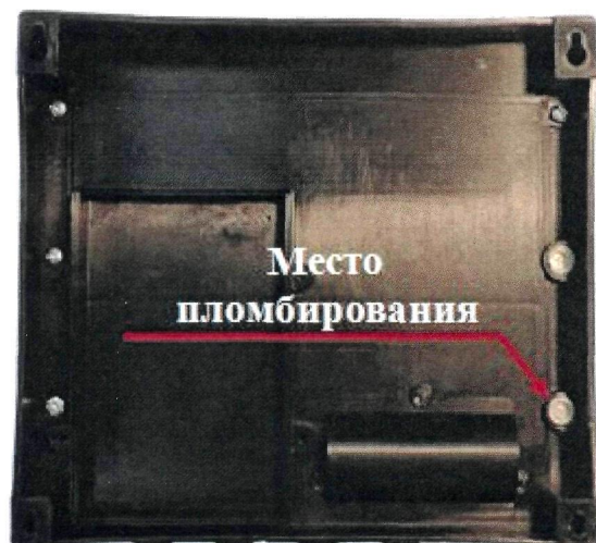
Рисунок 7 – Пломбирование тепловычислителя СПТ943
