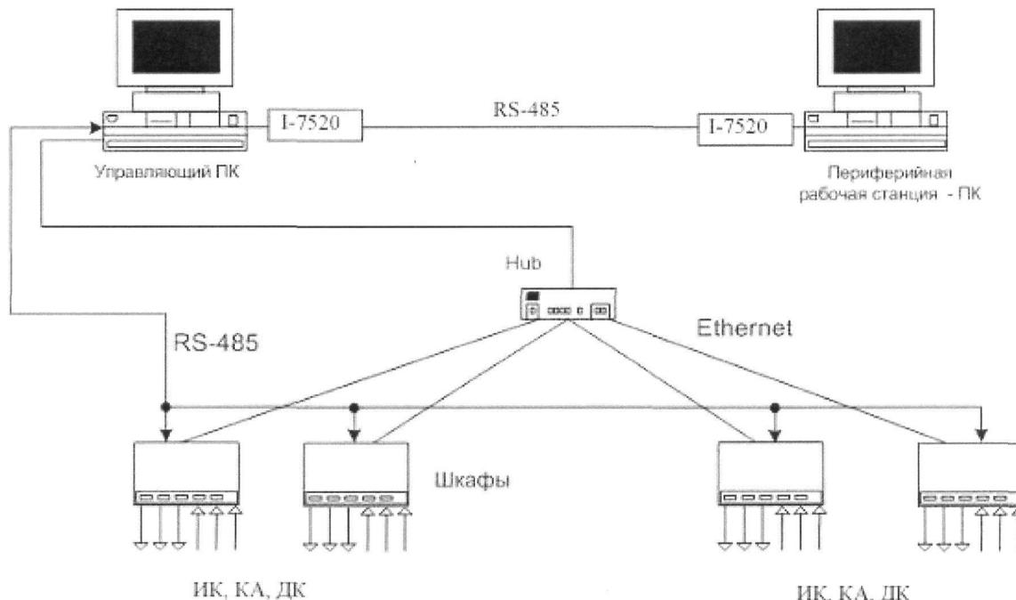
ИК – измерительный канал; ДК – дискретный канал ввода-вывода;
