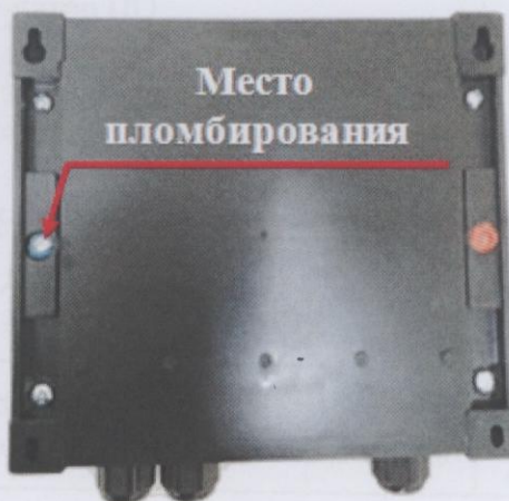
Рисунок 10 – Пломбирование тепловычислителя СПТ941
