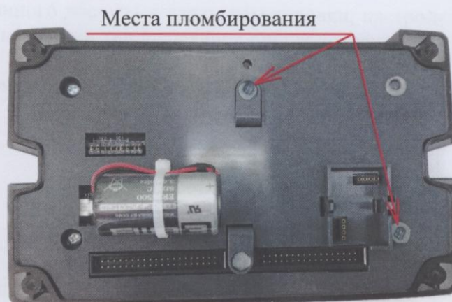
Рисунок 7 – Пломбирование тепловычислителя ВКТ-9
