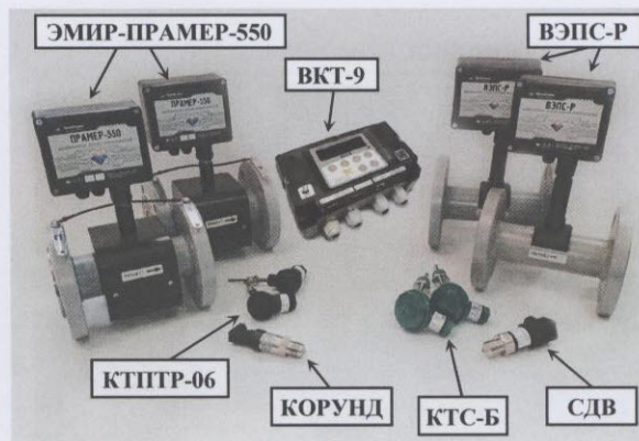
Рисунок 2 – Внешний вид теплосчетчиков исполнения 02
