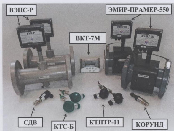
Рисунок 3 – Внешний вид теплосчетчиков исполнения 03
