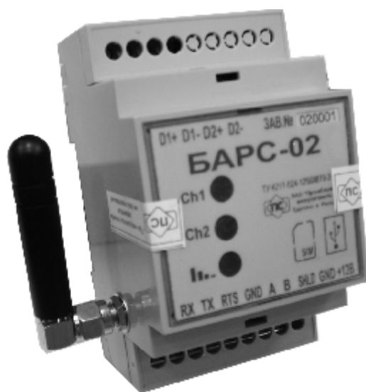
Рис. 5. Внешний вид блока с опломбированной лицевой крышкой.
