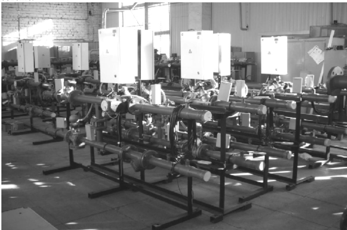
**Рис. 3. Блочные модули регулирования.**
