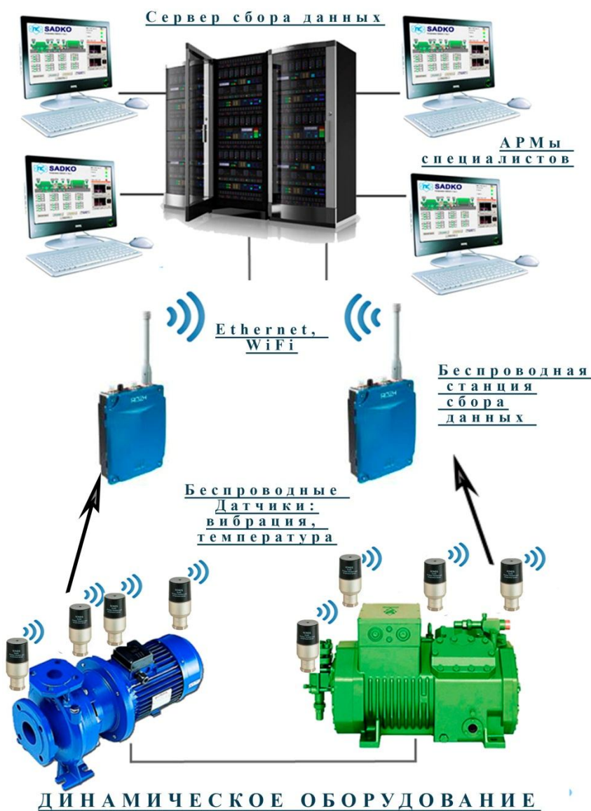
Рис.7. Логическая схема системы «САДКО» с беспроводными датчиками.
