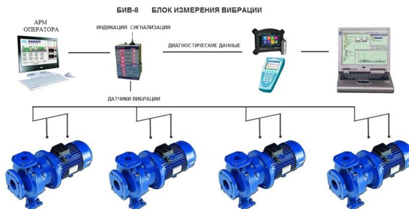
Рис.3 Структурная схема системы «САДКО-БИВ»
