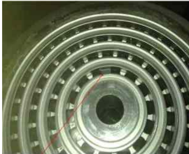
Рис.26. Фото всасывающего клапана 4-го цилиндра компрессора поршневого РТ1.4М16-12,5/17-281М1 поз.А-124.
