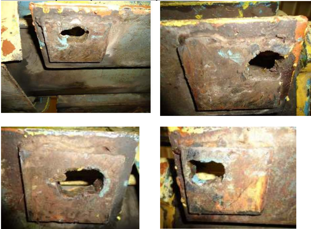
Рис.2. Фото опорных поверхностей лап электродвигателя.
