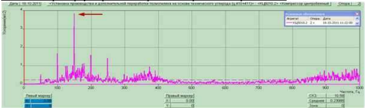
Рис.8. Спектр виброускорения. Опора №2- направление вертикальное
