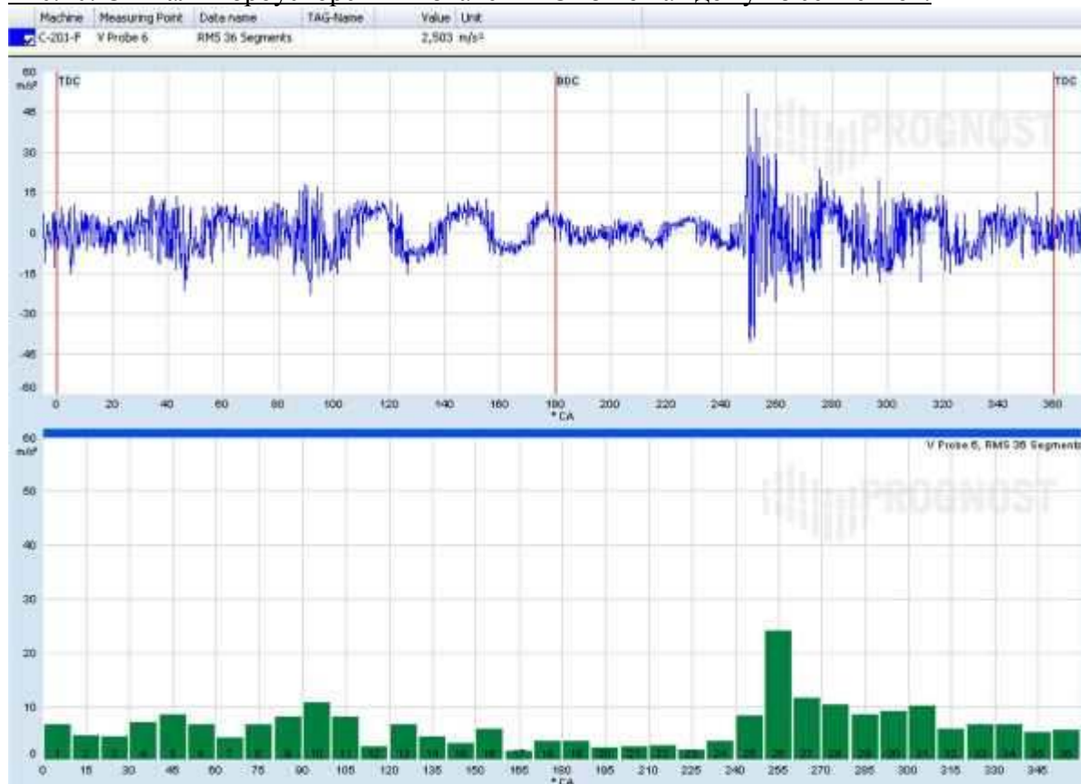
Рис.20. Сигнал виброускорения и значения СКЗ по каждому из сегментов.
