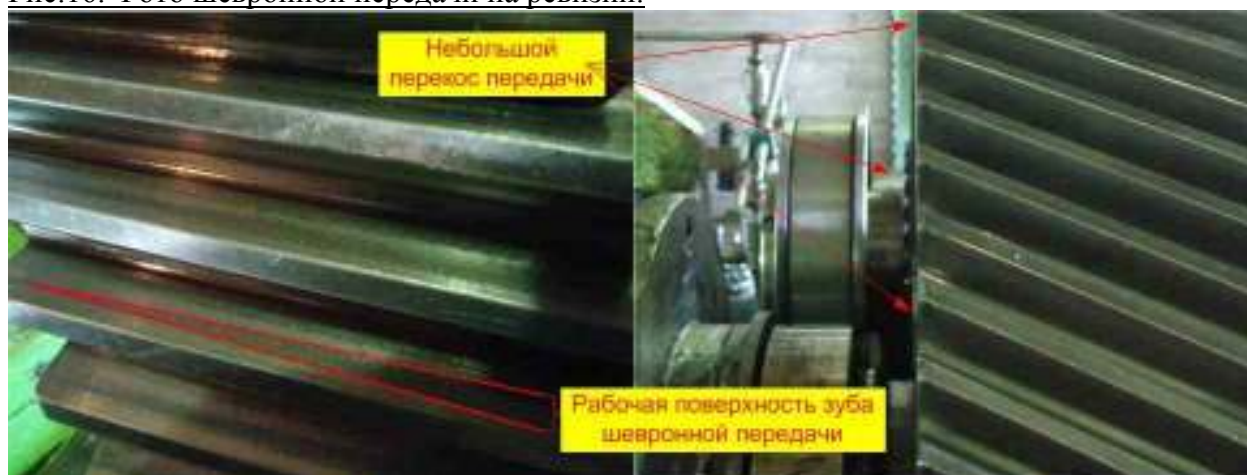
Рис.16. Фото шевронной передачи на ревизии.
