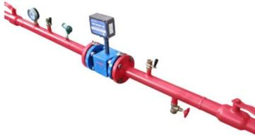
Состав: запорная арматура стальная фланец, преобразователь расхода ЭМИР-ПРАМЕР-550, термометр сопротивления, термоманометр, дренаж.
