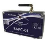
Система предназначена для автоматизации процесса сбора данных об интенсивности перевозок пассажиров на наземных транспортных средствах (автобусы, трамваи, троллейбусы). Принцип действия основан на подсчете, с помощью инфракрасных датчиков системы, количества пересечений пассажирами дверных проемов.
