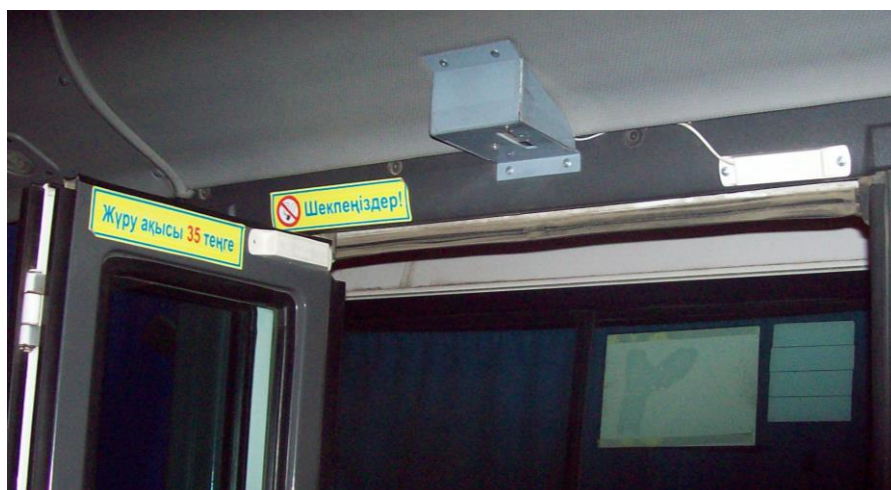
Рисунок 3.2 – Установка на одностворчатую дверь ИК-датчика «Луч-М».
