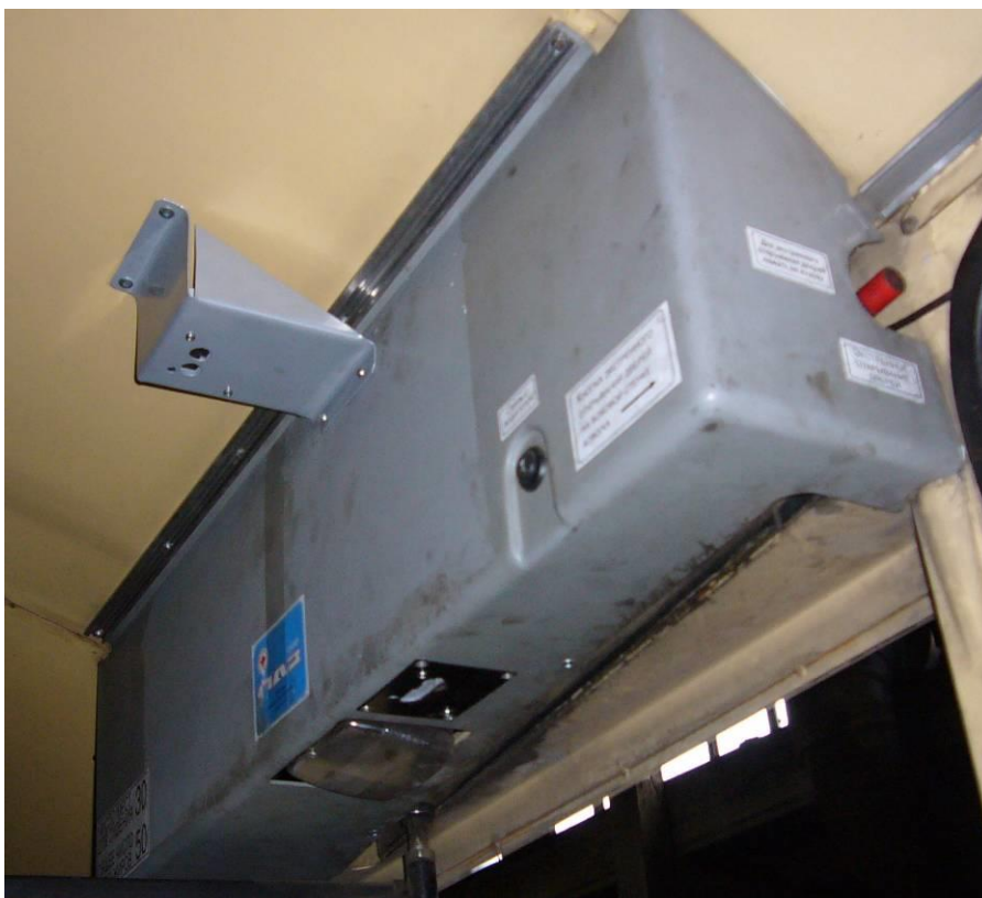
Рисунок 3.4 – Установка на одностворчатую дверь автобуса ПАЗ ИК-датчика «Луч-МС».
