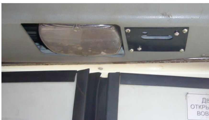
Рисунок 3.3 – Установка на одностворчатую дверь автобуса ПАЗ ИК-датчика «Луч-М».
