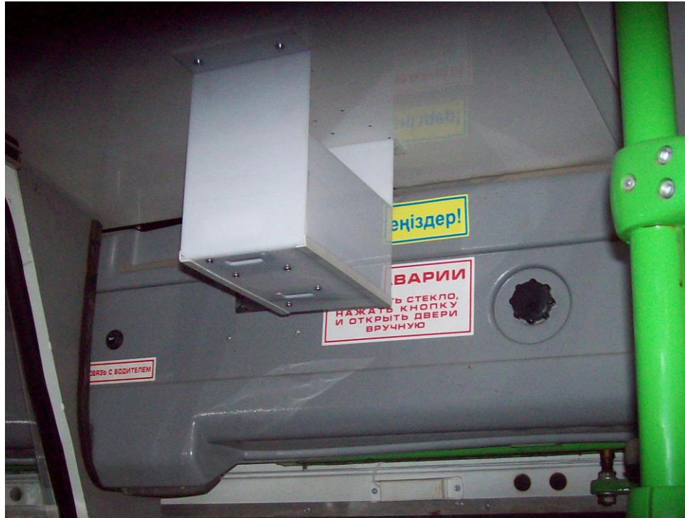
Рисунок 3.1 – Установка на одностворчатую дверь автобуса ЛиАЗ ИК-датчика «Луч-МС».
