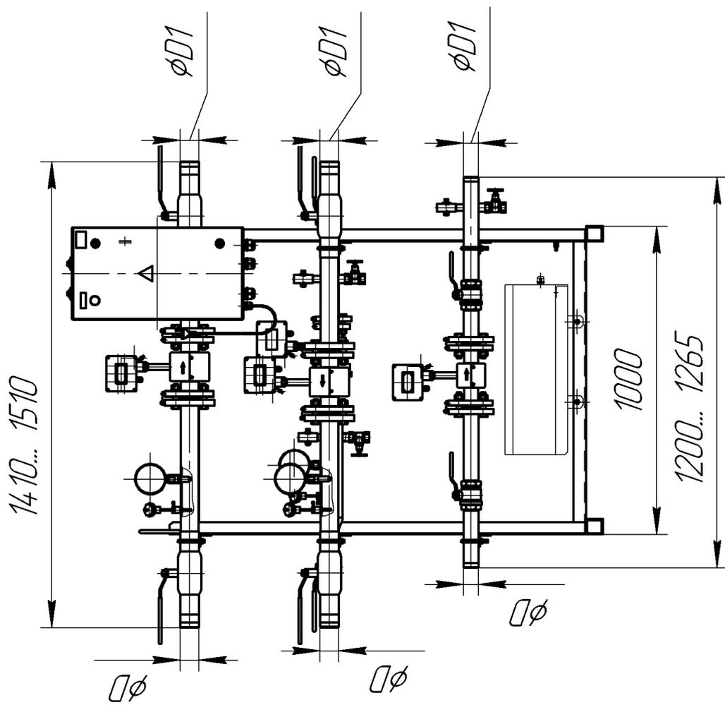
Рисунок А.3 - Габаритные и присоединительные размеры
