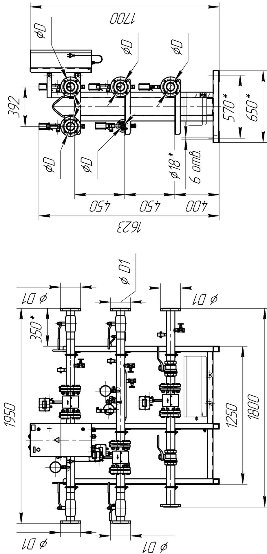
Рисунок А.1 – Габаритные и присоединительные размеры БМУ-08 (6 мм)
