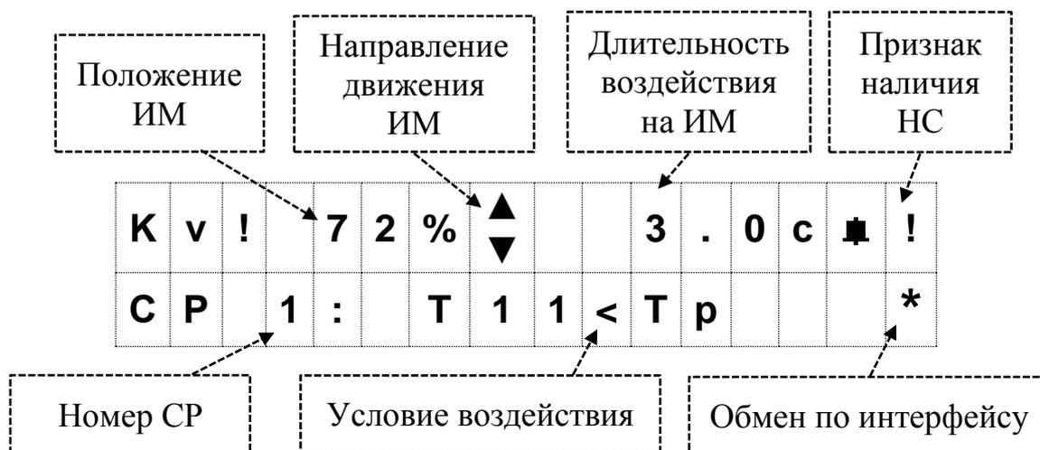
Рисунок 10 – Вид экрана индикатора в дежурном режиме
