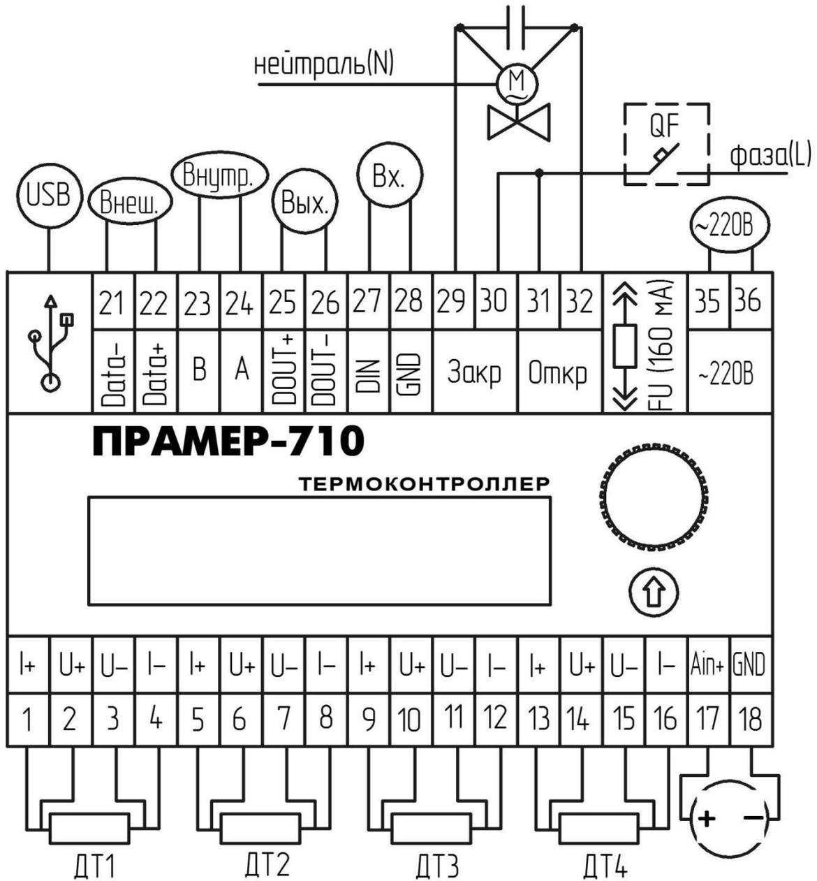
Рисунок Б.1 – Назначение клемм подключения внешних устройств
