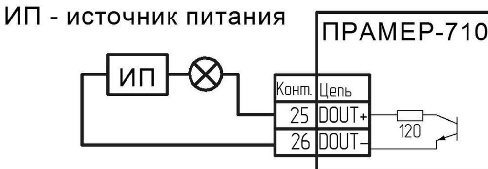
Рисунок 22 – Подключение к дискретному выходу контроллера.
