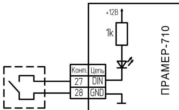
Рисунок 21 – Подключение к дискретному входу контроллера.
