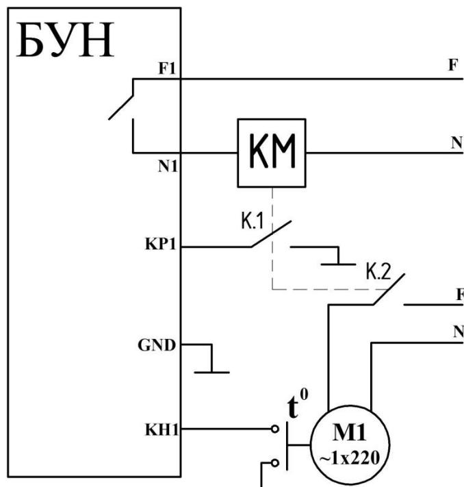
Рисунок 9 – Схема контроля сигналов аварии и запуска насоса.
