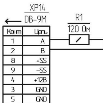
Рисунок 4– Схема подключения терминального резистора
