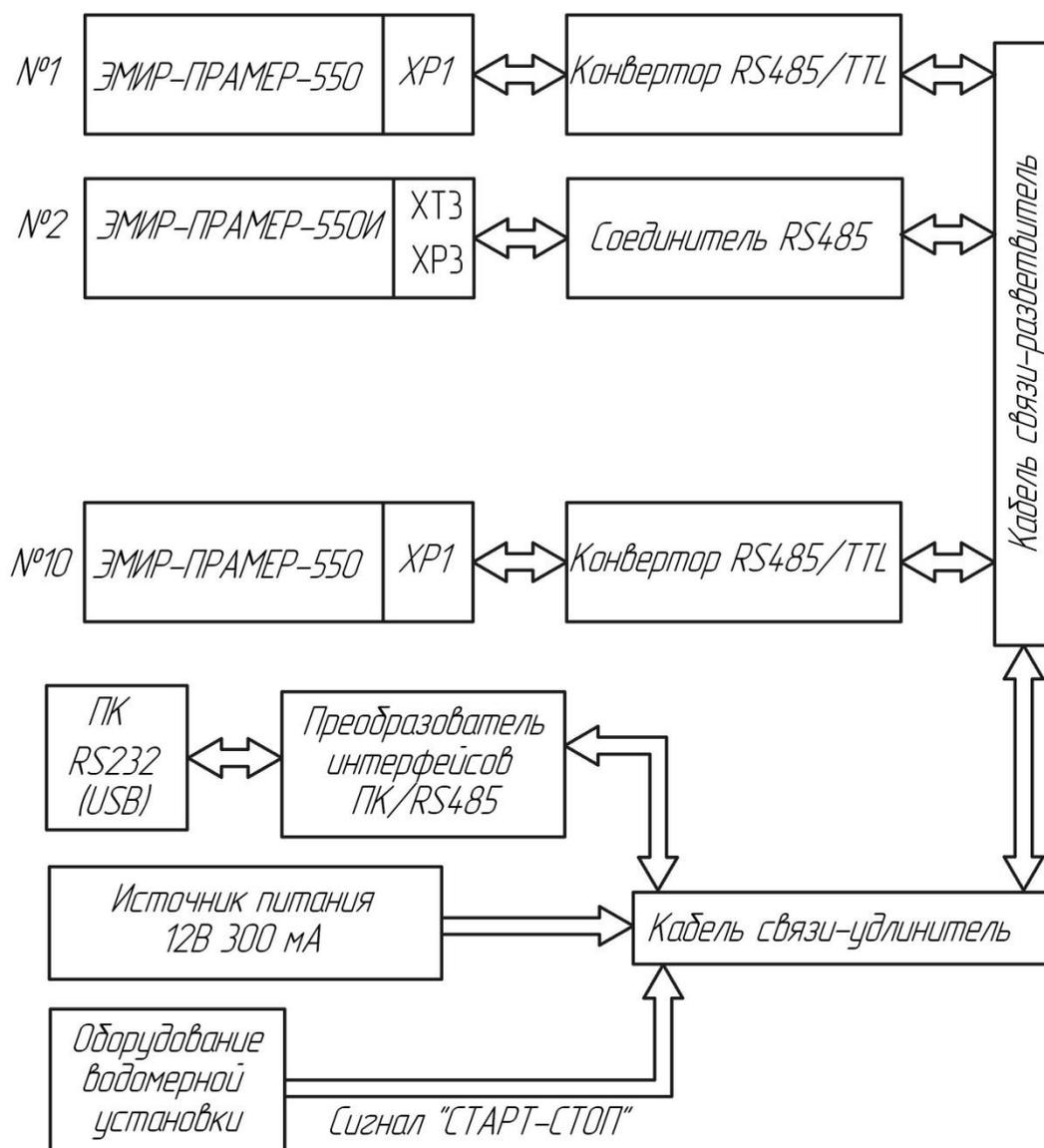
Рисунок 1 – Структурная схема подключения ПТК
