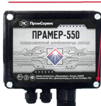
Рисунок 4 - Пломбирование ПР ЭМИР-ПРАМЕР-550
