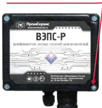
Рисунок 3 - Пломбирование ПР ВЭПС-Р
