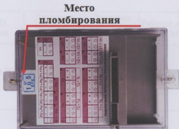
Рисунок 8 – Пломбирование тепловычислителя ЭЛЬФ
