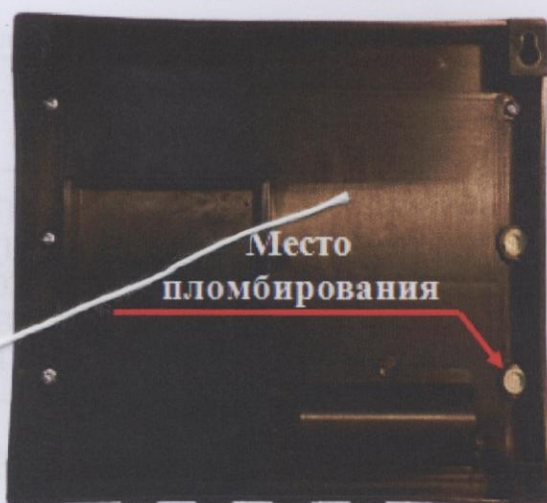
Рисунок 7 – Пломбирование тепловычислителя СПТ943
