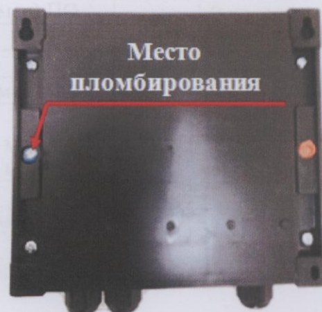
Рисунок 6 – Пломбирование тепловычислителя СПТ941
