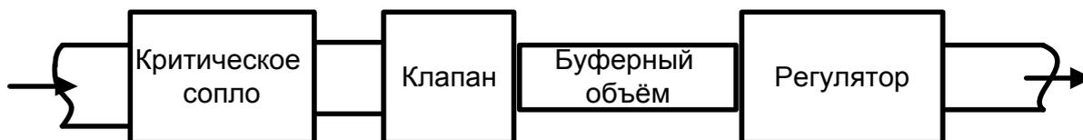
**Рис. 2. Структурная схема импульсного расходомера газа.**
